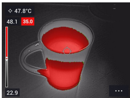
Alarm powyżej: Podświetla wszystkie piksele o temperaturze powyżej określonego poziomu.
